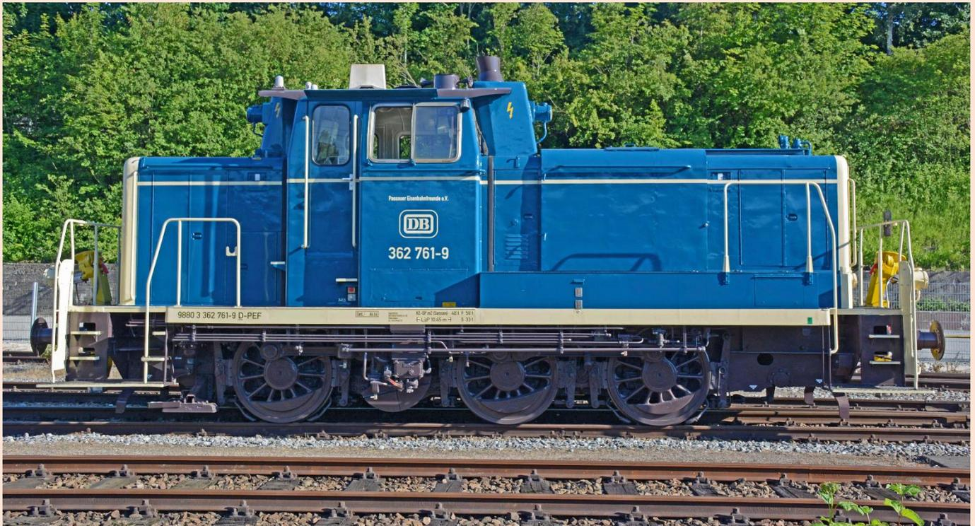
Seit Dezember 2015 ist die 362 761-9 im Eigentum der PEF. In fünf Monaten wurde sie betriebsbereit aufgearbeitet. Auch diese Maschine gehört zu einer Rangierlokbaureihe, die noch von der DB modernisiert und umgebaut wurde. Sie ist bereits mit Rangierkupplung, Funkfernsteuerung und Caterpillar-Motor ausgestattet.
