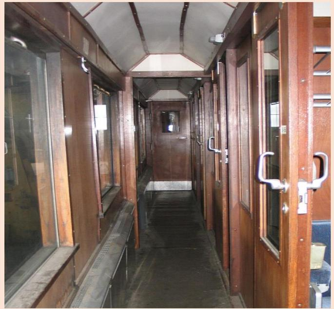
Seitengang zum Zugang für 7 Abteile
