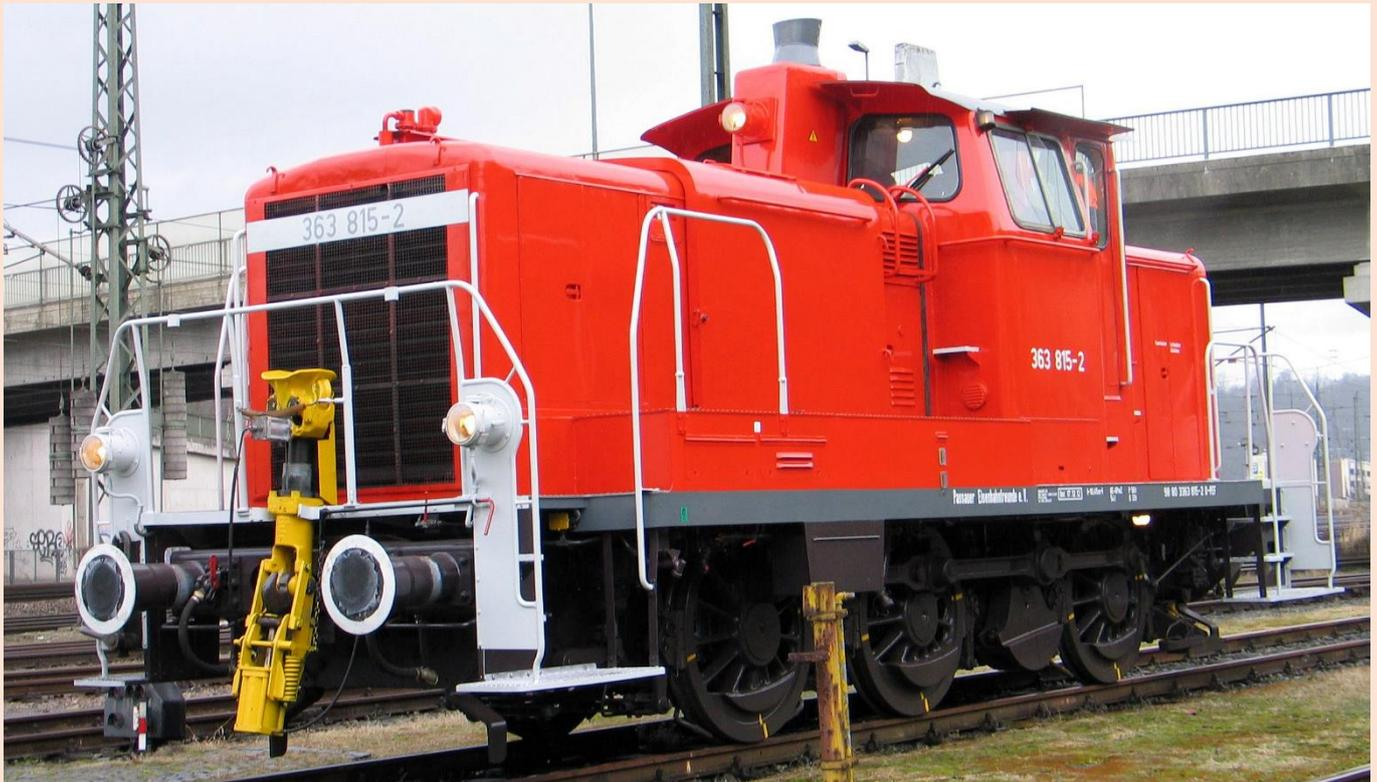
Seit Dezember 2012 ist die 363 815-2 wieder in Betrieb, eine Rangierlokombaureihe, die auch heute noch bei der DB im Einsatz ist. Sie ist bereits modernisiert mit Rangierkupplung, Funkfernsteuerung und Caterpillar-Motor.
