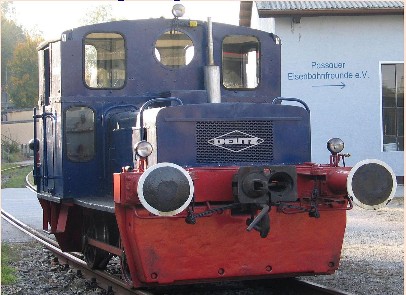
Der „Auerhahn“ war einst Werkslok in den Stahlwerken Peine-Salzgitter und rangierte Erzwagen mit Mittelpufferkupplung in die Werkstatt. Luftgekühlter Deutz-Motor mit 21KW/28PS für 13km/h
